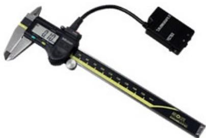
従来ノギスによる測定では、測定、結果の手書き、データ入力という工程が発生していた。テレメジャーを用いれば、送信機のボタンを1回押すだけでデータ入力まで可能。
