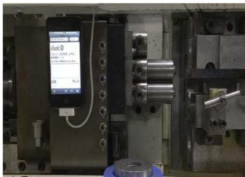
センサの代わりにスマートフォンを機械に設置し、内蔵された加速度センサで機械の稼働状況を把握。取得したデータは「BIMMS」に反映され、現在までの製造部品数の経時変化を見える化。作業員自身も画面で生産状況を把握できるためペースメーカーとしても機能。
