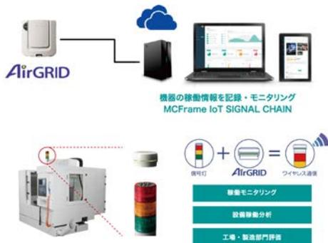
AirGRID WDが信号灯の情報を読み込み、そのデータを無線で送信。設備の稼働状況等を把握可能。
