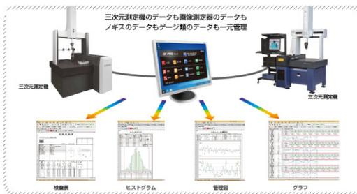
QCプロにより、測定機データから、検査表、測定のばらつき、管理表、各種グラフ等を即時見える化可能。
