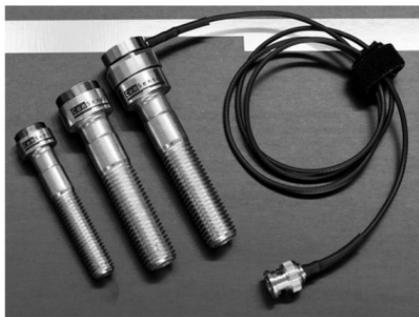
ボルトに加えられた圧力をセンシングする圧電素子（ピエゾ素子）が内部に、組み込まれており、ピエゾボルトで締結した箇所の荷重変動を高精度に測定することが出来る。ボルトに接続したケーブルからの信号はPC上に蓄積。応答周波数は最大70～80kHz程度まで。
