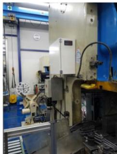
(右図) 生産設備に取り付けられたIoTツール「Σ軍師」。様々なメーカー及び種類の機械に取り付けられる。
