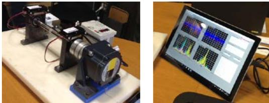
上記実験では、モーターのシャフトにつながる軸受に振動センサを取り付け、各センサデータを無線で送信。タブレットに取り付けている受信機で取得したデータを波形データとして表示している。正常時と異常時の2種のデータが得られているが、正常時と異常時では波形の形が大きく異なり、異常検知に利用できる。
