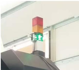
光センサのデータを取得し、無線でデータを送信するための機器
