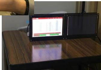
工場・事務所に設置したディスプレイ、モバイル端末など、様々な端末から、炉の温度、製品生産数、注文情報等を閲覧可能。また、製造現場からデータは蓄積され、不良が発生した際の原因分析等に利用も可能。
