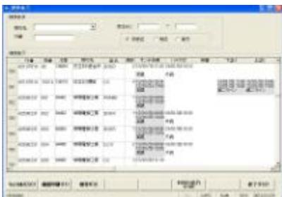
(左図) 各工程の作業開始、終了をバーコード入力し、部品1品毎にタイムリーな進捗状況を管理。インターネットで顧客側から進捗状況がリアルタイムで確認可。
